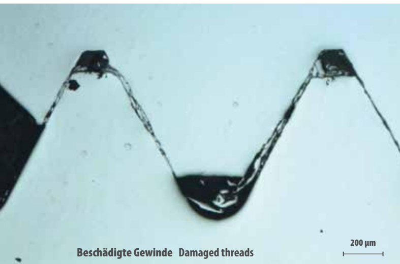
Gebrochener Gewindegang Broken thread
